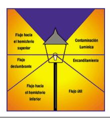
✓ Eficacia: Las lámparas tienen capacidad para convertir la electricidad en luz visible. La calidad de la luz emitida es dividida entre la potencia (W) utilizada para determinar su eficacia Esta calidad se expresa en lúmenes entre vatios (Lm/W), lo que mide la eficiencia energética de la lámpara.
